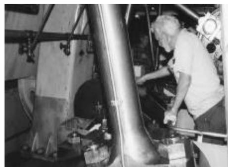
Le graisseur de quart tâte la tête de bielle du cylindre « moyenne pression ». La machine tourne à 33t/mn .Au premier plan apparaît la bielle du cylindre « basse pression (ph FR)
