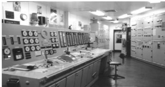
Partie arrière du centre de manœuvre du « Gérard LD ». On peut voir sur le pupitre les deux leviers de démarrage du moteur : le lancement à l'air comprimé à gauche et le cran de pétrole et changement de marche à droite.. Il est intéressant de comparer cet ensemble de commandes et de surveillance, avec celui des Liberty ships, ou même de cargos des années 1960.
