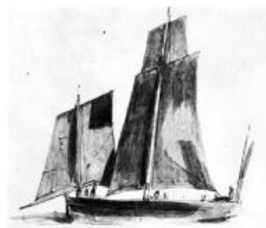
Le gréement de Houry (pas de foc à l'avant a été utilisé durant la première moitié du XIX
